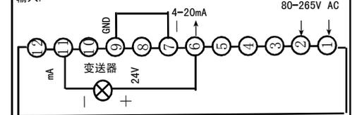
2、与称重电阻应变式压力传感器连接, 要求提供 DC 12V/40mA 激励电压, 传感器激励输出为 2mV/V, 软件选择 mV 输入。
